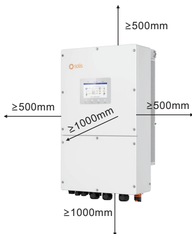
Figura 3.5 Distâncias para montagem do inversor
